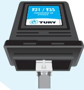
**Funcionamento normal:** o conector do chicote está conectado no do variador.
