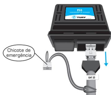
2) Conectar o chicote de emergência no chicote do variador, reestabelecendo a conexão original do sistema de ignição do veículo.
